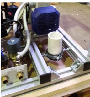
4. Наденьте трубу отвода льда на латунный патрубок холодильной камеры, предварительно отжав вверх кнопку концевика затора
